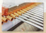
Nur aus natürlichen Zutaten bestehen die insgesamt 19 verschiedenen Füllungen. Stets frisch zubereitet, werden sie mit hoher Präzision abgefüllt, immer 56 Hüppen auf einmal.
