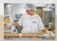
Linienführerin Manuela Richard prüft visuell und mit der Waage die Hüppen auf vollständige Füllung. Ein Spiegel am Laufband zeigt dazu deren verborgenes Ende.
